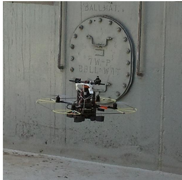
El robot aeri durant una de les missions de prova a bord d'un vaixell transportador de contenidors.
