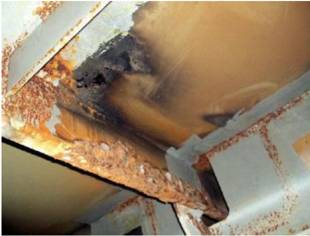
Exemple de la detecció de corrosió a bord d'un vaixell utilitzant la tècnica WCCD.
