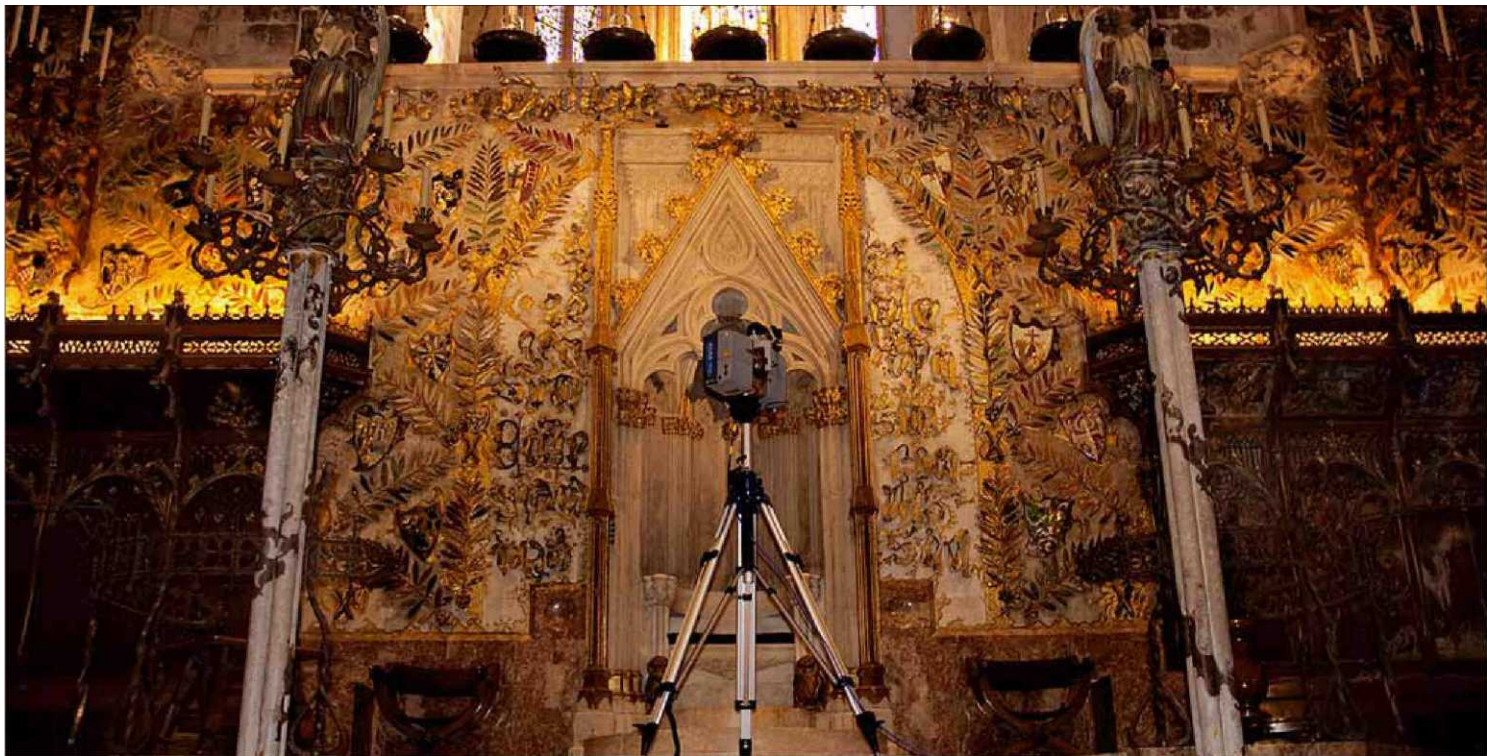
Escáner láser 3D, colocado en uno de los puntos de la capilla Real de la Seu de Palma, desde donde se realizó el escaneo de las estructuras. / IMAGEN CEDIDA POR LA UIB
