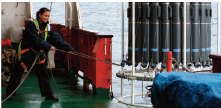
El CTD i la Roseta han estat els instruments de mostreig més importants de la campanya ESSASI. El CTD (inicials de Conductivity- Temperature-Depth) i els sensors que duu acoblats mesuren diferents propietats de la columna d'aigua, des de superfície fins al fons, com ara pressió, temperatura, salinitat, oxigen o fluorescència. Les ampolles de la Roseta (la part més visible de l'instrument a la fotografia) permeten recollir mostres d'aigua de fins a 24 fondàries diferents.
