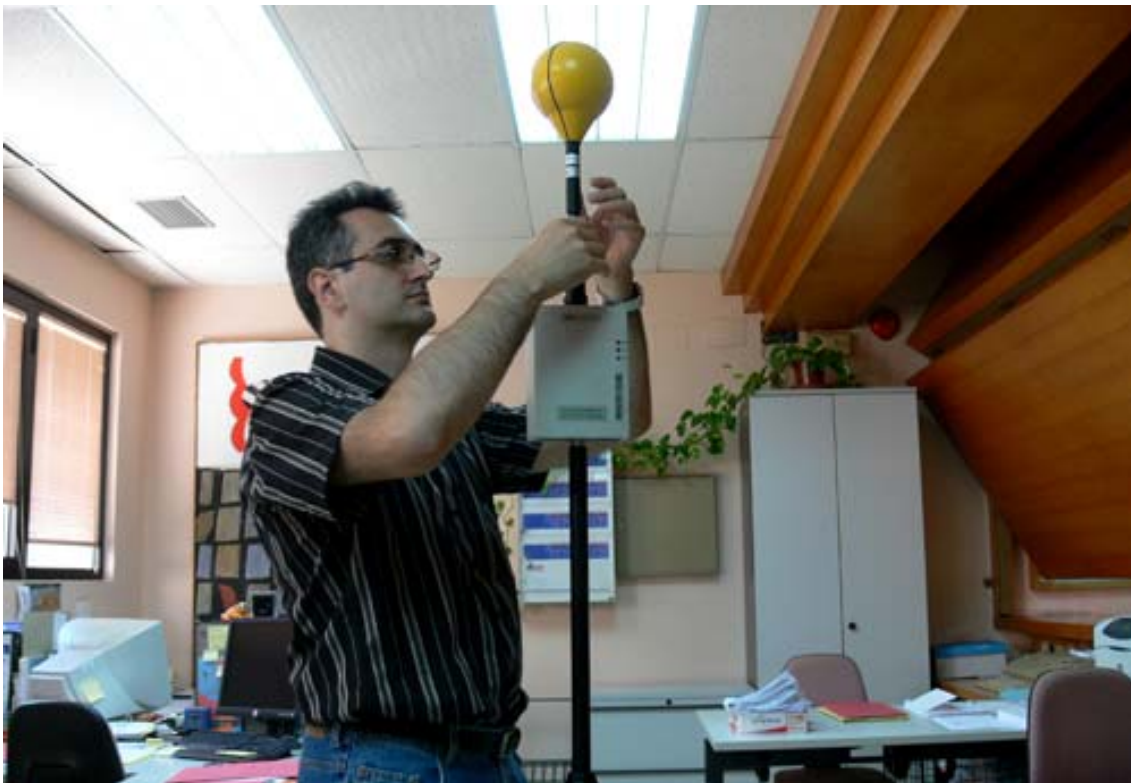
Figura 1. El doctor Rodrigo Picos instal·lant una sonda per mesurar camps electromagnètics, en aquest cas de baixa freqüència.
